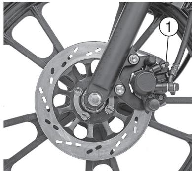
Рис. 14. Дисковый тормоз переднего колеса
