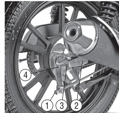
Рис. 16. Регулировка заднего тормоза и натяжения цепи
