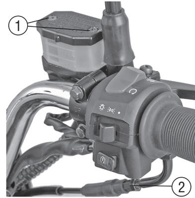
Рис. 15. Главный тормозной цилиндр
